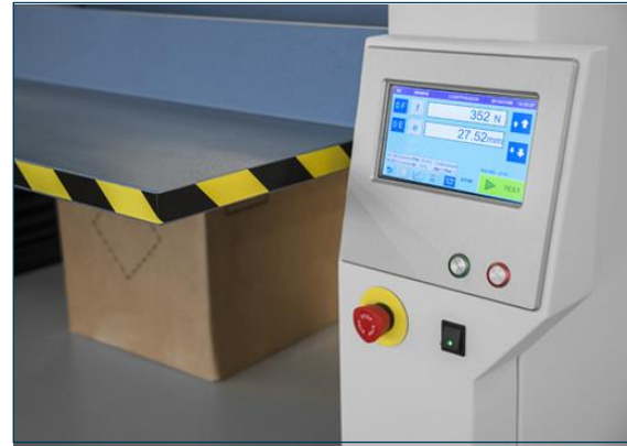
Touchdisplay und Sicherheitsschalter an der Vorderseite des Geräts
