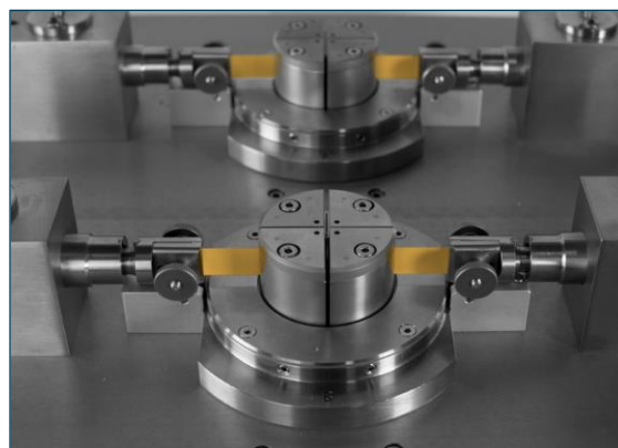
zwei Proben werden gleichzeitig gefalzt
