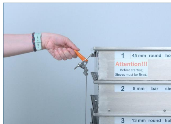
System szybkiego mocowania/zwalniania
