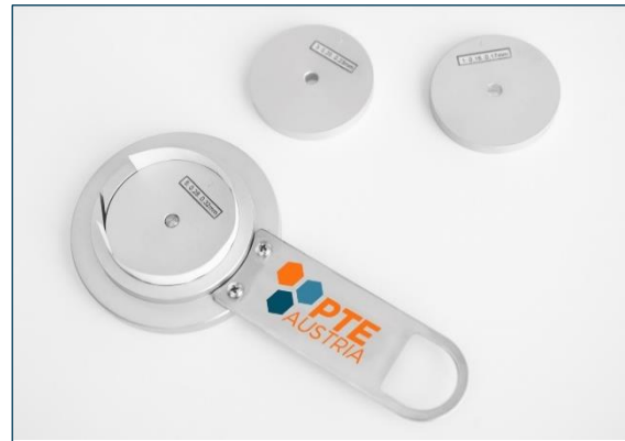
Test zgniatania pierścieni (RCT)
