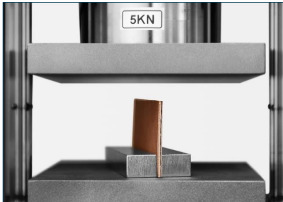
Test zgniatania krawędzi (ECT)
