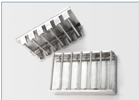
Test przyczepności szpilek (PAT)
