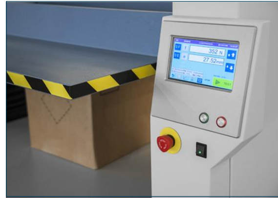
Panel dotykowy i wyłącznik bezpieczeństwa z przodu
