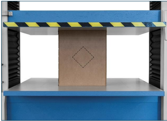
Próbka umieszczona pomiędzy płytami
