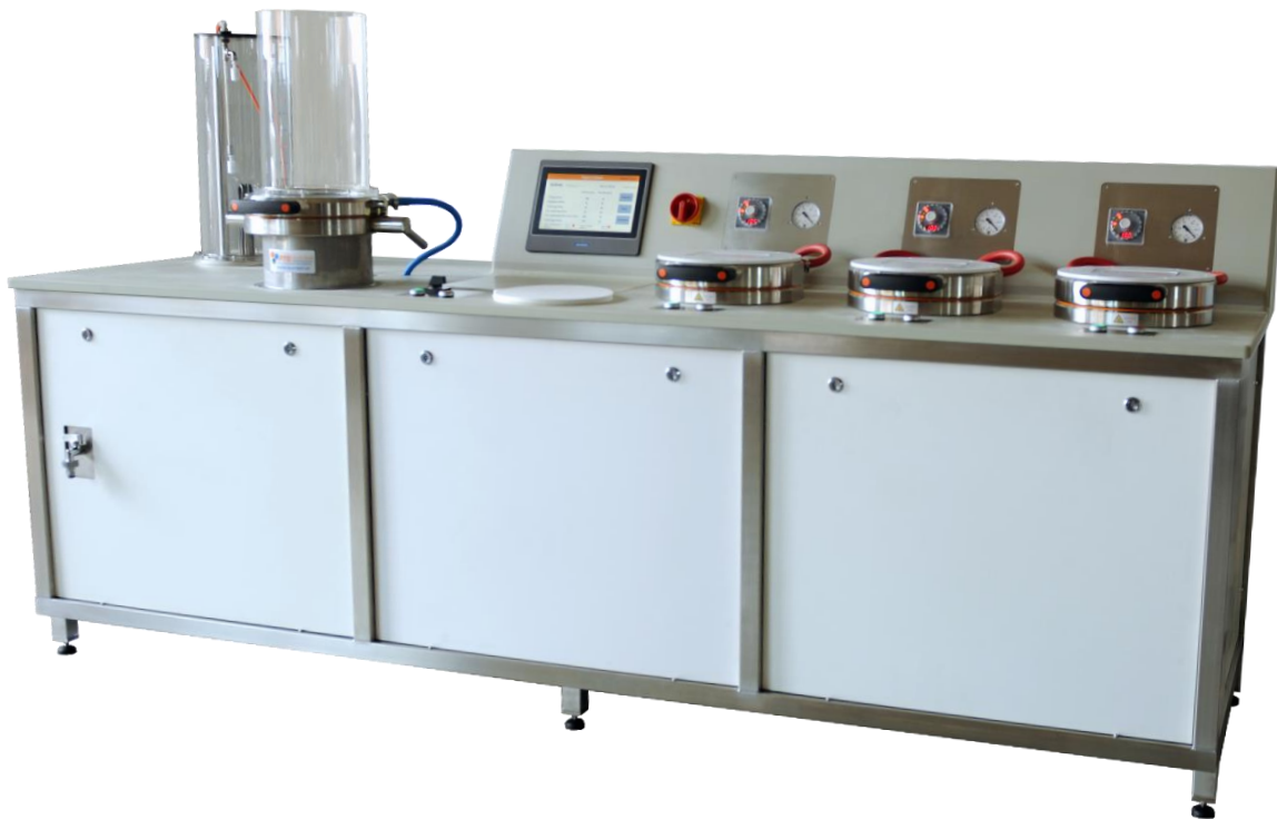
Automatyczny model Rapid Köthen z cyrkulacją białej wody i trzema suszarkami
