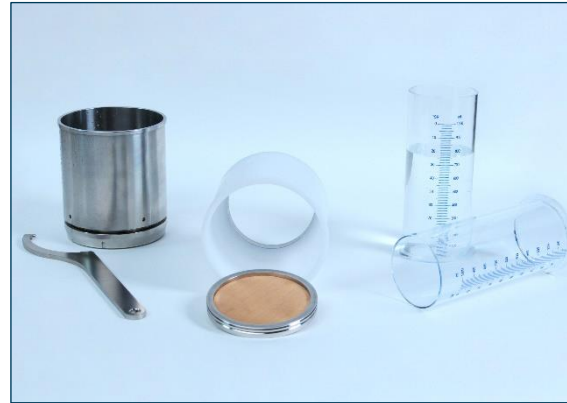
Komory drenażowe i zlewki pomiarowe
